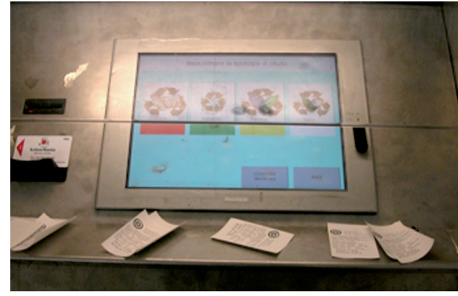
L'ingresso dei rifiuti è regolato dalla tessera magnetica che registrerà direttamente alla sede di gestione del servizio
